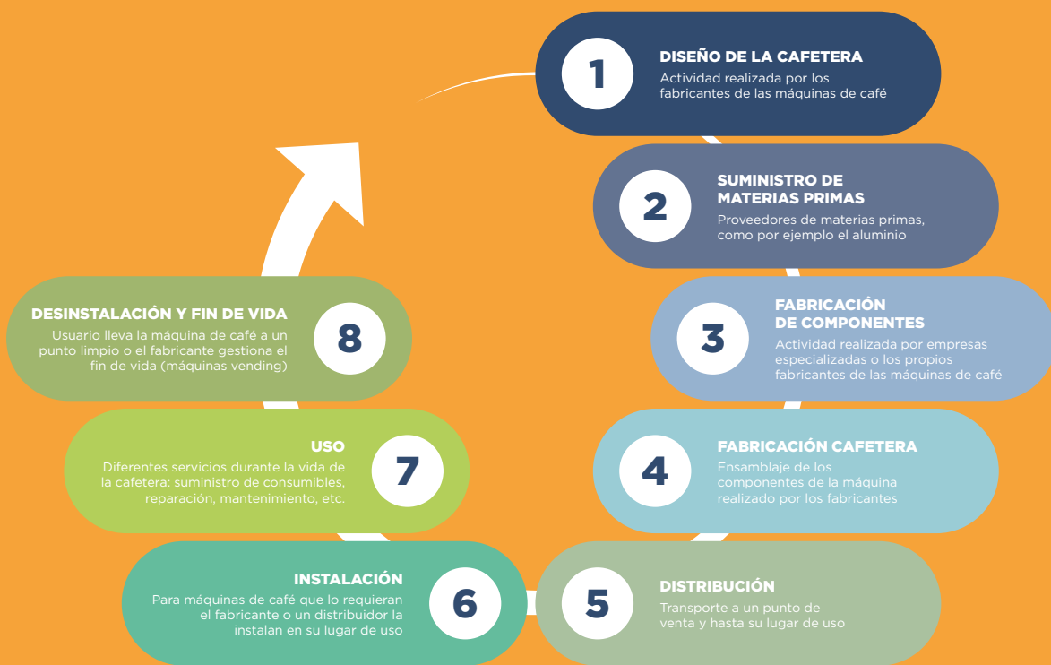
Figura 12. Agentes implicados en el ciclo de vida de una máquina de café
